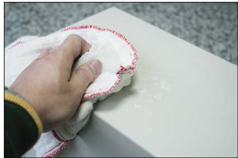
圖 2-48 利用乾淨的抹布和清潔劑，清除機殼表面的污漬
