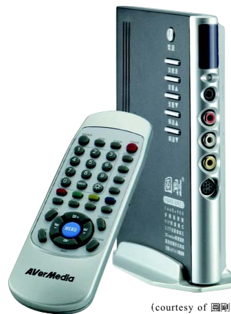
圖 2-40 電視盒 透過此設備可利用電腦來收看電視節目
