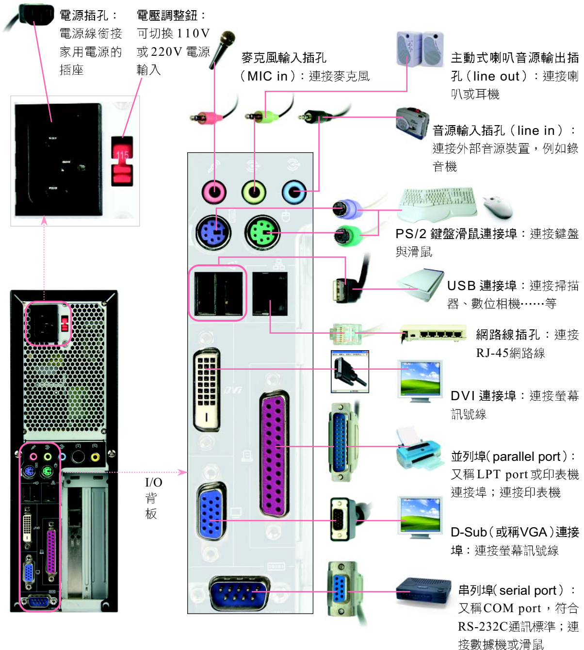
圖 2-4 個人電腦主機背面的插孔
