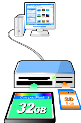
圖 2-25 使用讀卡機來取得記憶卡中的數位影像
