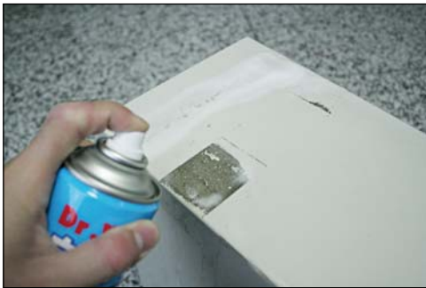
圖 2-48 利用乾淨的抹布和清潔劑，清除機殼表面的污漬
